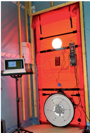
Blower door test Source photographe : Eric Legret
